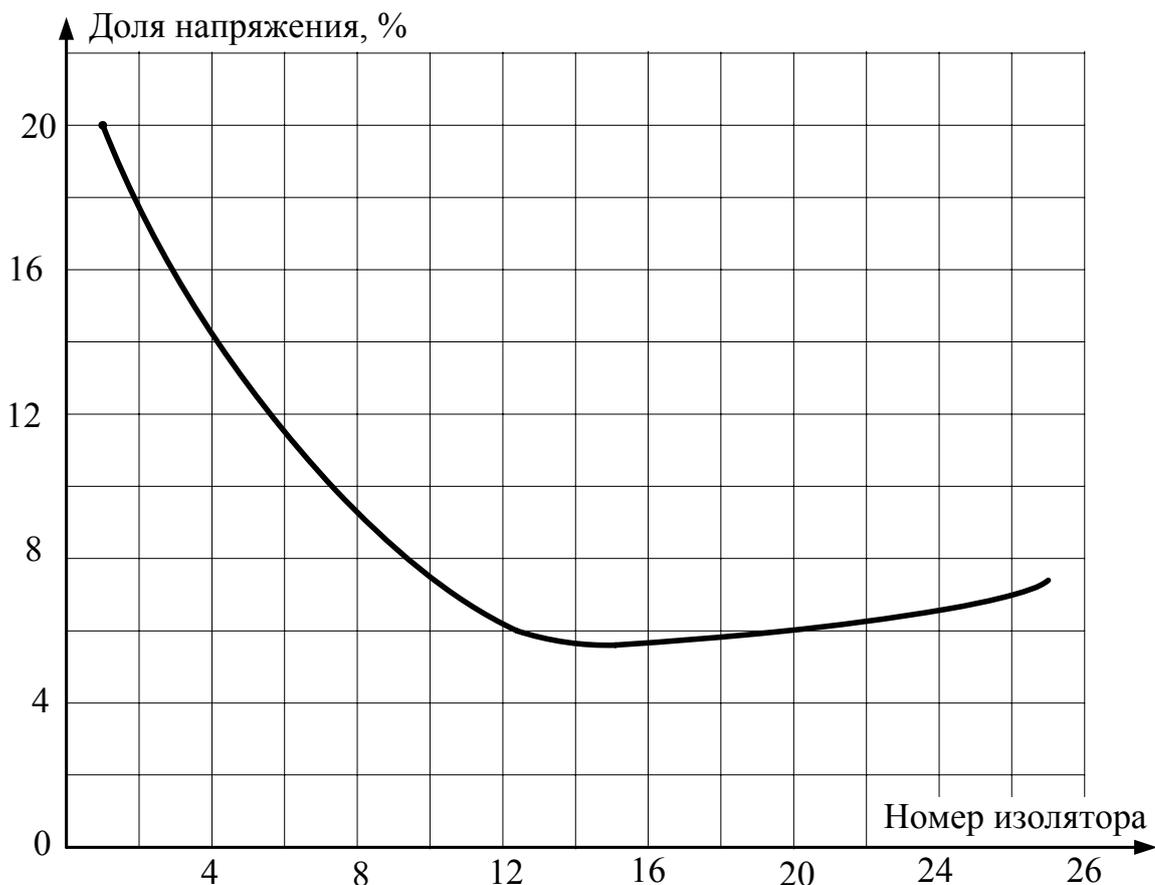
Рис. 2.2. Распределение напряжения на гирлянде изоляторов
