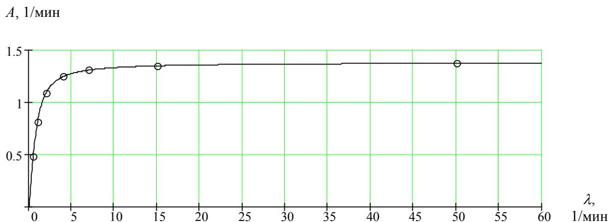
Рис. 3 Зависимость абсолютной пропускной способности АТС от интенсивности входного потока
